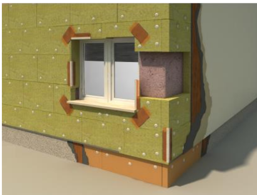
Slika: Primjer postavljanja kamene vune na fasadu
